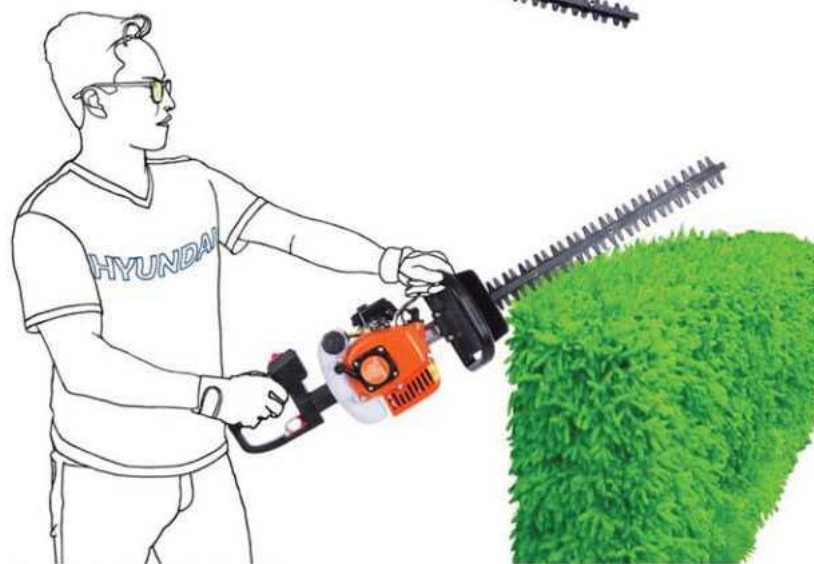
A gép tartása függőleges (oldalsó) vágáskor
